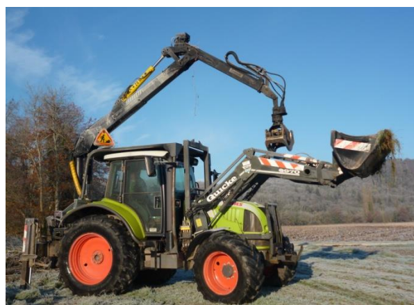
Engin avec Grue forestière + Godet chargeur
